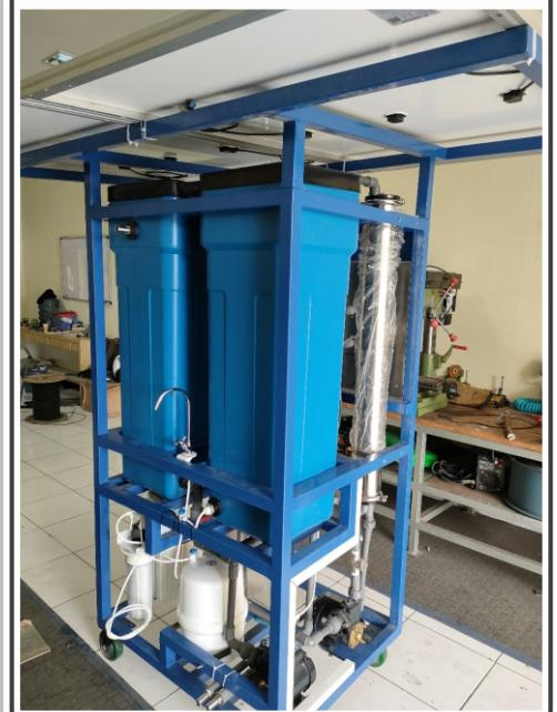
Portable IPAM Tenaga Surya menghadirkan air minum siap konsumsi di mana pun, kapan pun — sepenuhnya bertenaga surya. Dengan kapasitas hingga 150 liter per jam, sistem ini beroperasi tanpa bergantung pada jaringan listrik, menjadikannya solusi andal untuk wilayah terpencil dan tanggap darurat.
